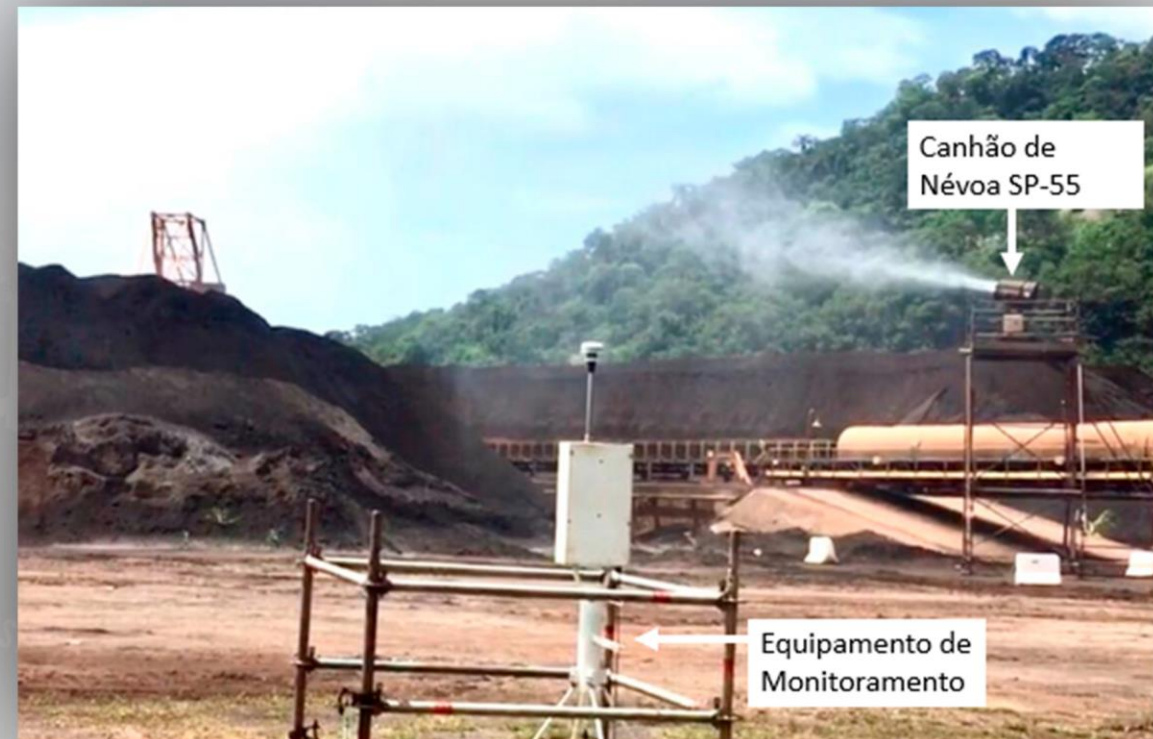
Figura 2. Funcionamento do canhão de névoa em teste
